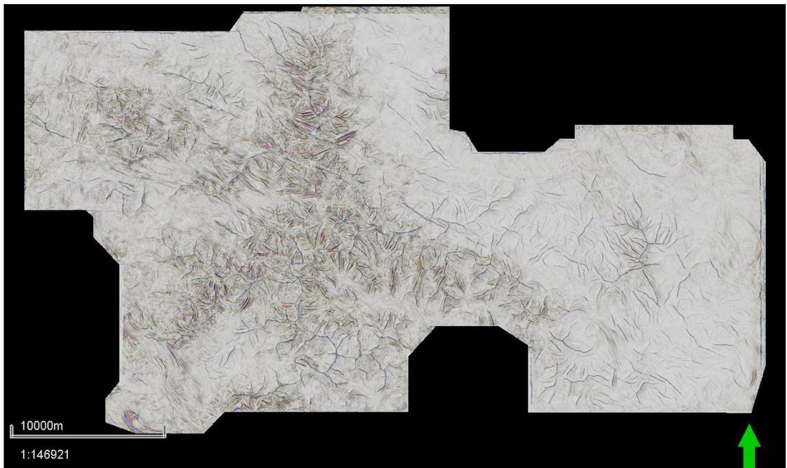
Рис. 3. Срез куба Ant Tracking, наложенный на срез куба рассеянных волн на глубине 2550 м
