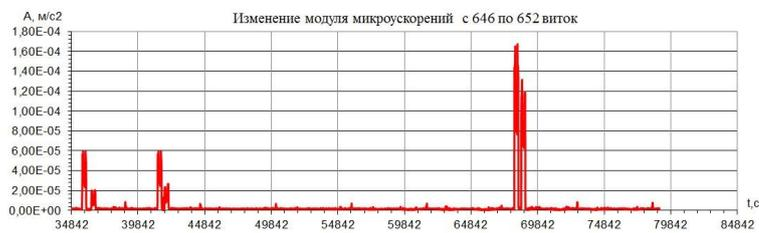
**Рис. 3.** График изменения модуля интегральных значений микроускорений ( $A$ ) на контрольных промежутках времени
